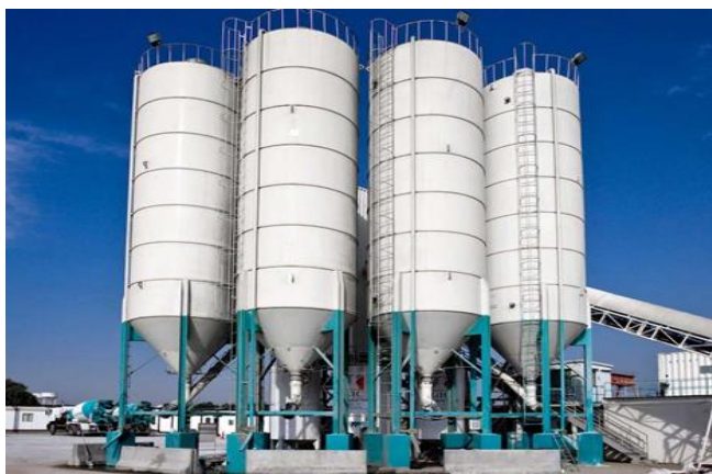
Рисунок 1.17- Силосы для хранения цемента
